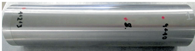
Рис. 2. Внешний вид проб после исследования на ультразвуковой установке UTS-750
