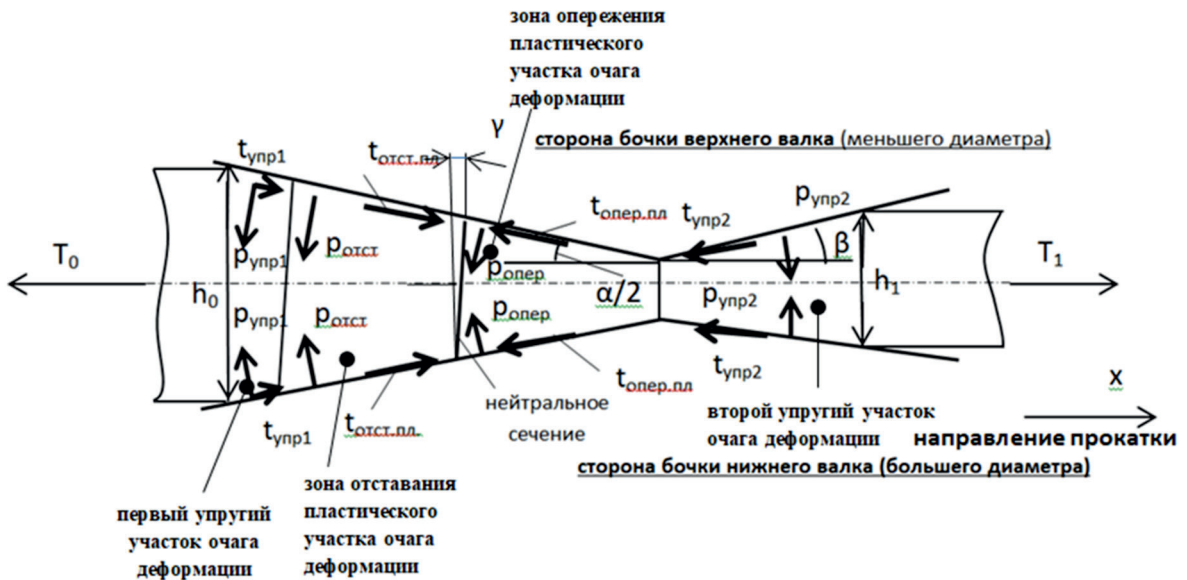
Рис. 1. Структурная схема одного из вариантов асимметричного очага деформации:
