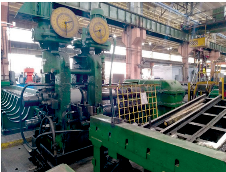
Рис. 3. Лабораторный одноклетевой стан холодной прокатки «400»
