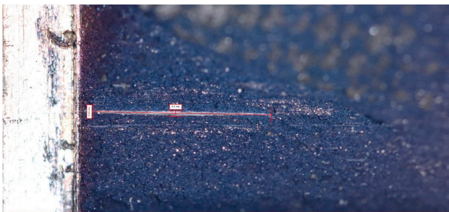
Рис. 7. Макровключение в «синем изломе»
