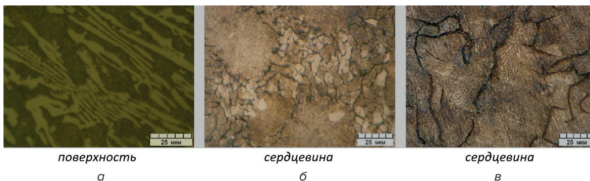
Рис. 6. Микроструктура ФКГК, полученного с использованием металлического холодильника (а) и вставки из плакированной смеси (б), \times 1000 , травление 4%-ный раствор \text{HNO}_3
