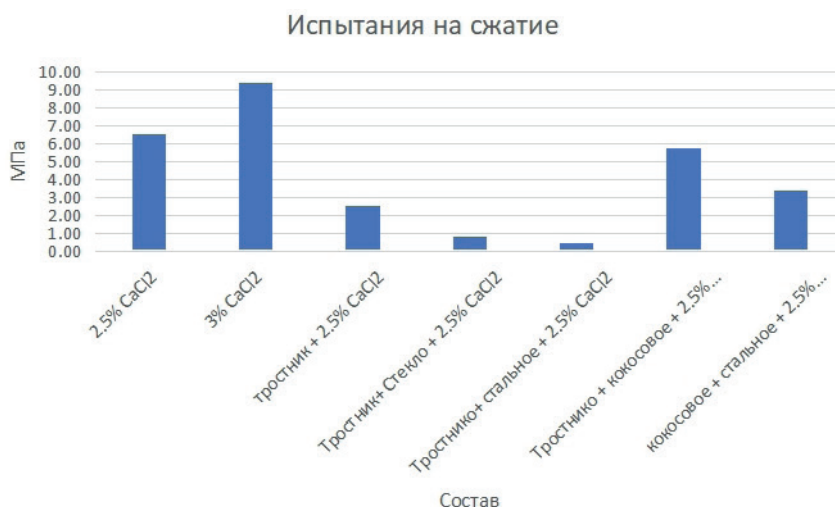
Рис. 5. Значения прочности на сжатие пенобетона с водоредуцирующими добавками CaCl 2 2,5 и 3 %
