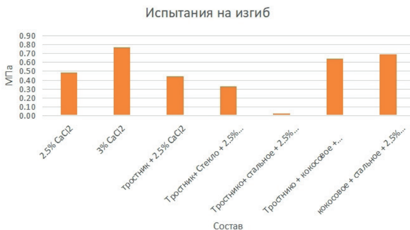
Рис. 6. Значения прочности на изгиб пенобетона с водоредуцирующими добавками CaCl 2 2,5 и 3 %
